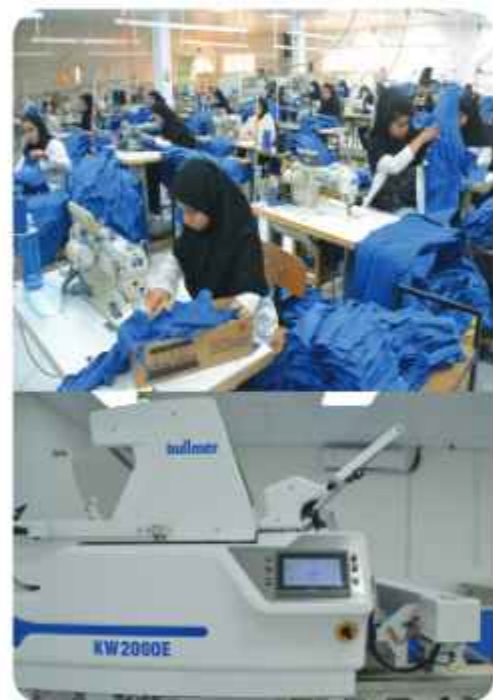
خط آتش نشانی، پیراهن و دستگاه طاقه پهن کن بولمر آلمان در برش
